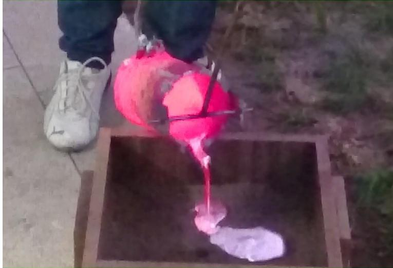
**Figura 3.11** – Alumínio líquido vertido no molde.
