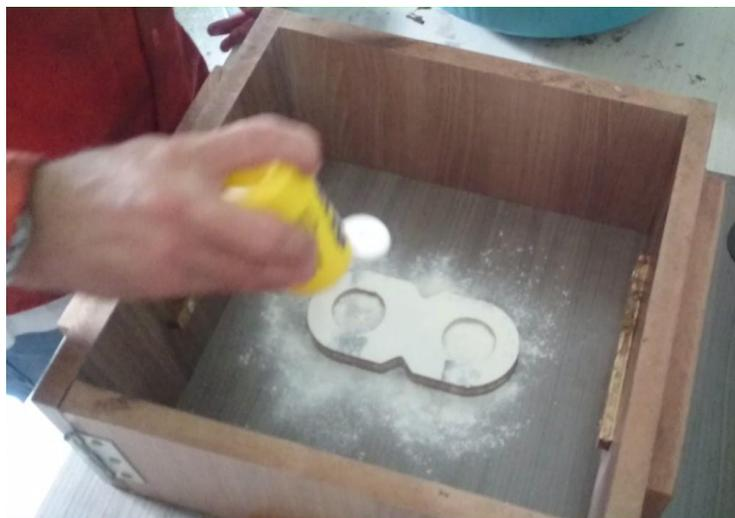
**Figura 3.3** – Aplicação do desmoldante (talco) sobre a peça.
