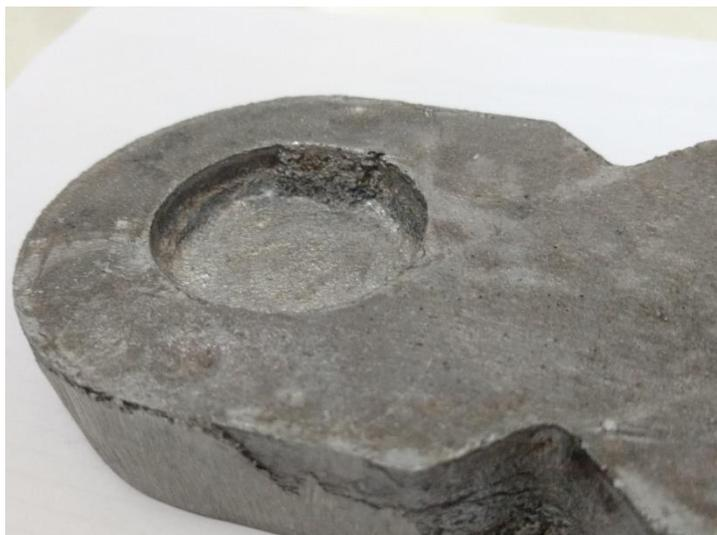
**Figura 4.4** – Detalhe da peça com porosidade e erosão.
