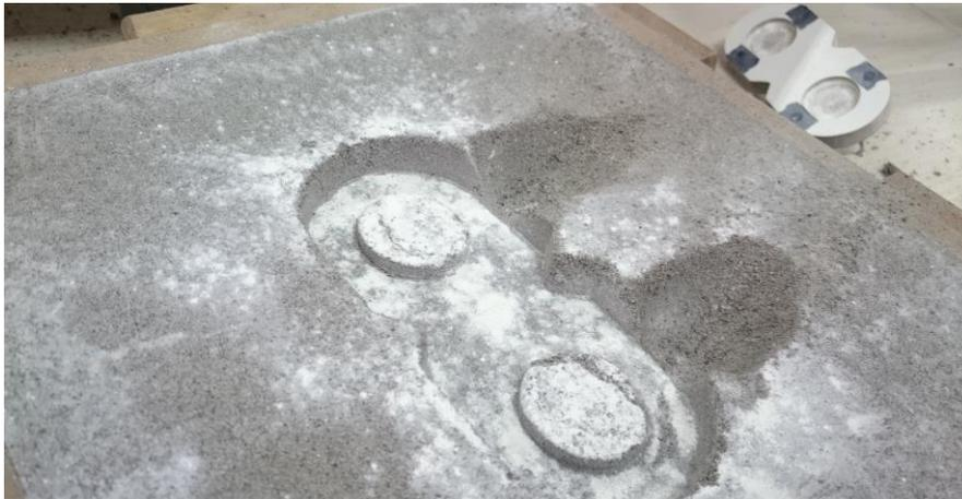
**Figura 3.7** – Em primeiro plano o molde e os canais de alimentação; no fundo, o modelo utilizado.
