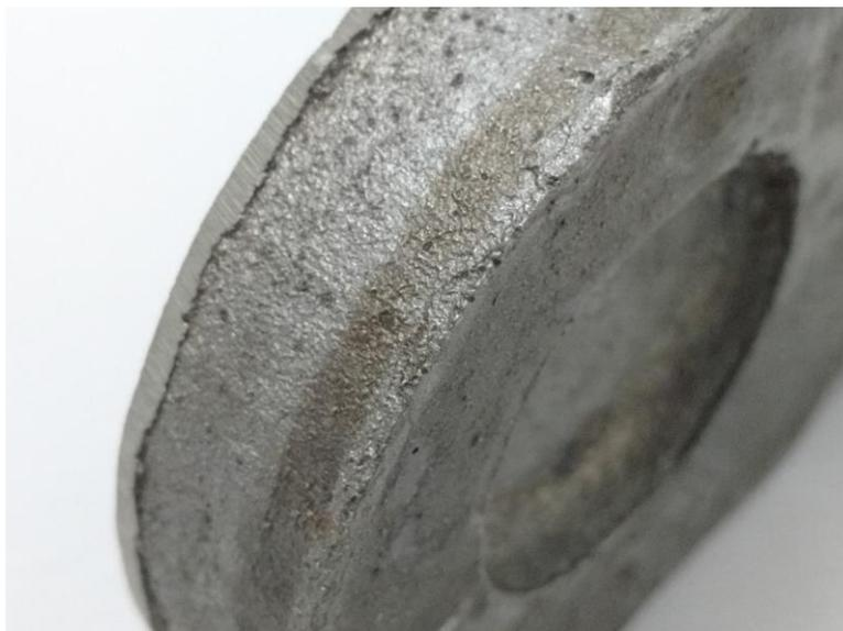
**Figura 4.3** – Detalhe da rugosidade da peça.
