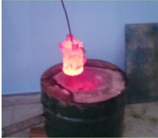
**Figura 3.9** – Retirada do cadinho do forno.
