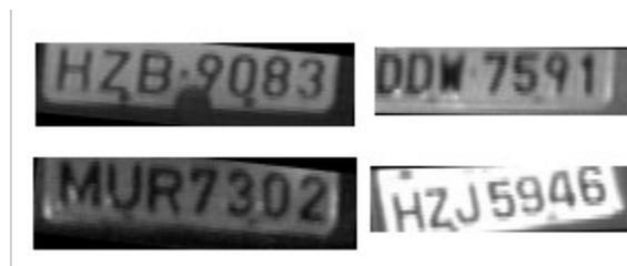
*Figura 30: Placas segmentadas com sucesso*
