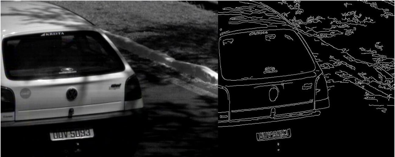
*Figura 14: Aplicação do operador Canny*
